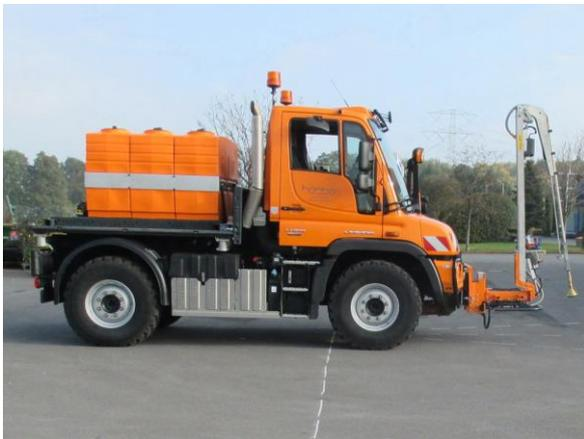
Das Tanksystem FTS 2550 mit einem Volumen von 2550 l und einem Gießarm FGA 1000.
