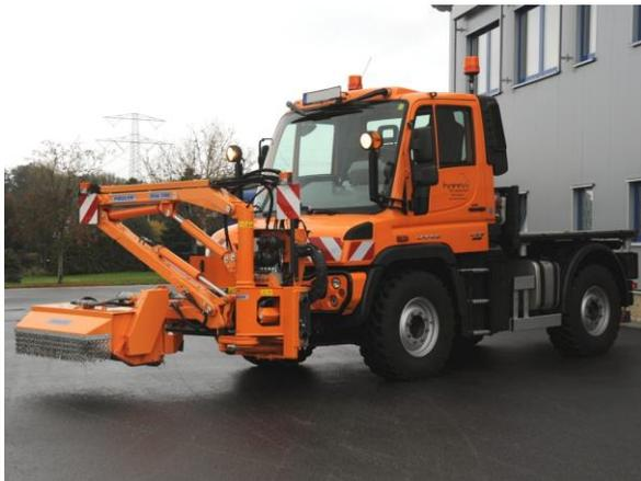
Frontauslegemäher FFA 500/700 mit fünf oder sieben Meter Reichweite am U318. Der Teleskoparm eröffnet je nach Arbeitswerkzeug eine umfangreiche Anwendungspalette.
